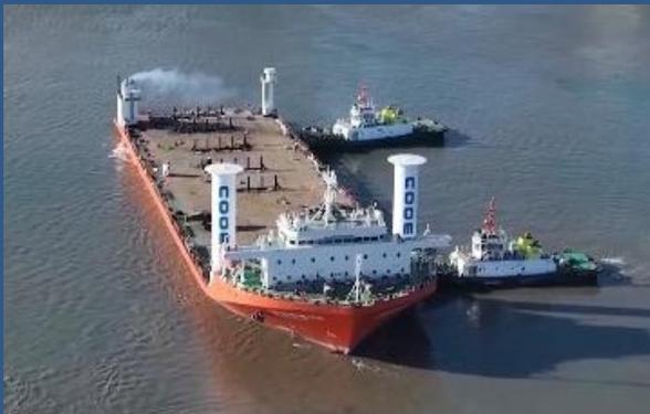
← 2023年12月20日、offshore oil engineering Co.,Ltd (COOEC)の船舶(海洋石油226船)にレトロフィットで搭載されたローターセイル
