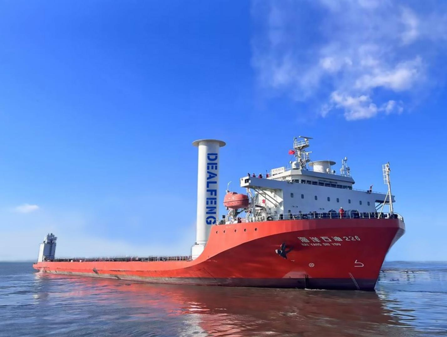
ローターセイル(フレットナーローター)は風力を利用して船舶の推力を補助する硬式帆で、搭載した船舶は燃料消費量を抑えつつ大気への排出物を削減することが出来ます
