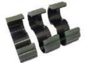
圧縮試験結果 ( 疲労試験 150,000 cycle 実施後, 低圧 )
