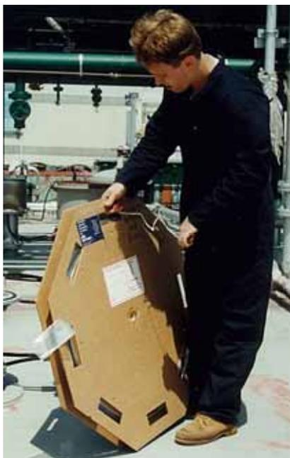
メトリテープ式液面センサーは、まるで「電線」のように、直径1.5メートルのリールに巻かれた状態で納入されます。
